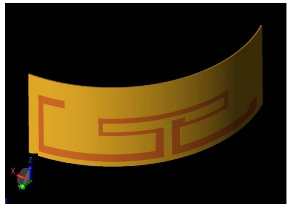
図2：マルチバンドアンテナの拡大3次元ビュー カメラ内部に湾曲して設置されるアンテナ同型のアンテナが反対側にも設置されている
