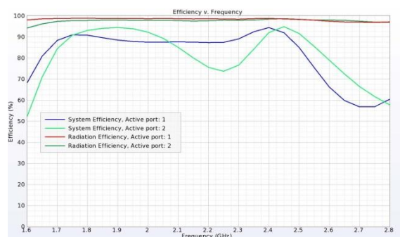
図6：デュアルバンドアンテナの放射効率とシステム効率
