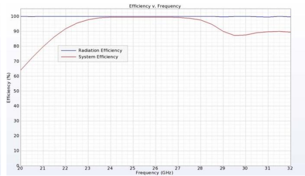
図6：誘電体共振器アンテナの放射効率とシステム効率 22GHzから29GHzで90%以上の優れた効率を実現している
