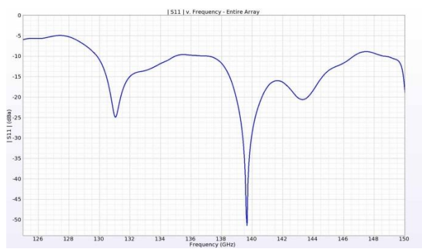
図18：アレイデバイス全体でのリターンロス 130GHzから146GHzにかけてほとんどが-10dB以下である
