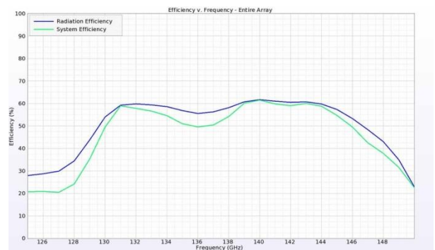
図28. アレイデバイスの効率 このアンテナアレイの効率は、対象となる全周波数範囲で約60%
