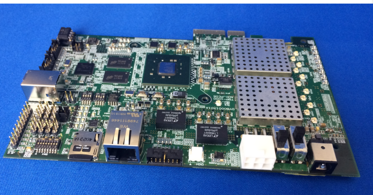
SDR-SAT搭載の多摩川電子製TSP-1009 SDRボード
